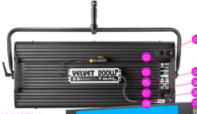
XLR-5 DMX RDM IN + OUT CONNECTOR LIGHT POWER BUTTON 02 UP AND DOWN SCROLL BUTTONS 03 **ENTER/+ & - ADJUSTMENT BUTTONS** 04 3200K / 5600K QUICK ACCESS BUTTON 05 MODE SELECTION/ LOCK BUTTON 06 07 **BACK BUTTON** MICRO USB CONNECTOR 08 **RJ-45 ETHERCON LAN CONNECTOR** 09 10 MAIN POWER SWITCH
